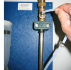
Beim ersten Auffüllen des Duftstoff-Behälters gelang automatisch Luft in den Pumpenkopf. Um eine sichere Funktion der Pumpe zu gewährleisten, muss diese entlüftet werden. Dazu muss der Pumpenschlauch vom Dosierventil abgezogen werden (s. Bild). Bei jedem weiteren Nachfüllen von Duftstoff muss die Pumpe nicht mehr entlüftet werden!
